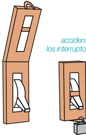
*Protéjase de las activaciones accidentales de energía asegurando los interruptores con dispositivos de traba*
